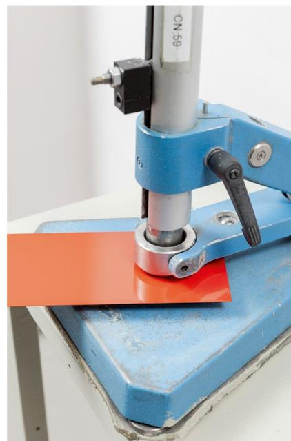
Stumpfmatt und äußerst kratzfest sind diese bei 160° aushärtbaren Pulverlacke. Sie versprechen einen niedrigen Energieverbrauch sowie Zeit- und Kostenersparnis.
